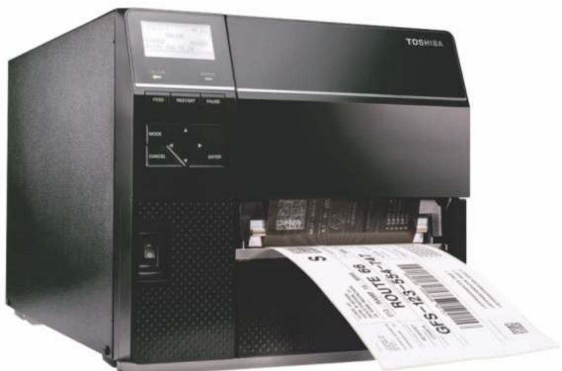
Imprimanta B-EX6T1 este durabilă și fiabilă, ca de altfel toate imprimantele Toshiba din seria B-EX, și are o carcasă solidă, ce se poate deschide în două direcții. Acest lucru are ca efect atât reducerea amprentei echipamentului, cât și crearea unui spațiu mai mare pentru accesul ușor la rolă de etichete sau la ribbon.
